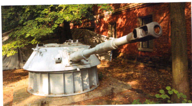
76-мм башня плавающего танка Д-56М образца 1950 года
